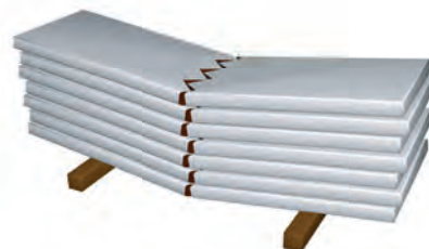
図2 悪い例 (角材が無い場合でも割れます)
